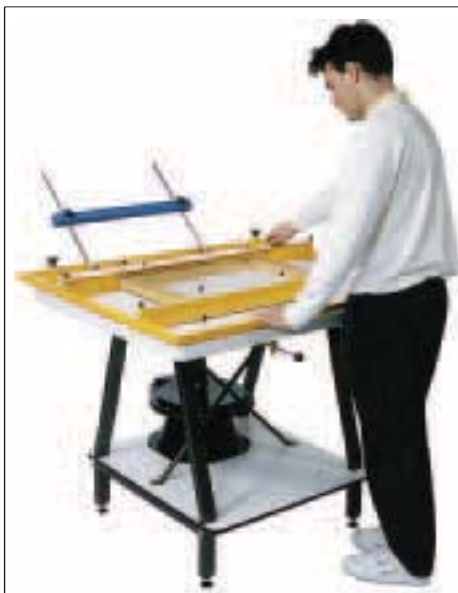
Рис.8. Стол трафаретной печати Screen Printing Units фирмы Mega Electronics
