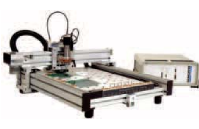
Рис.2. Сверлильно-фрезерный станок с ЧПУ фирмы Bungard
