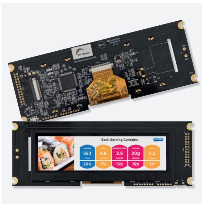
Рис. 6. Дисплейный TFT-модуль RFS520C-ELW-DBN типа Bar с платой контроллера
