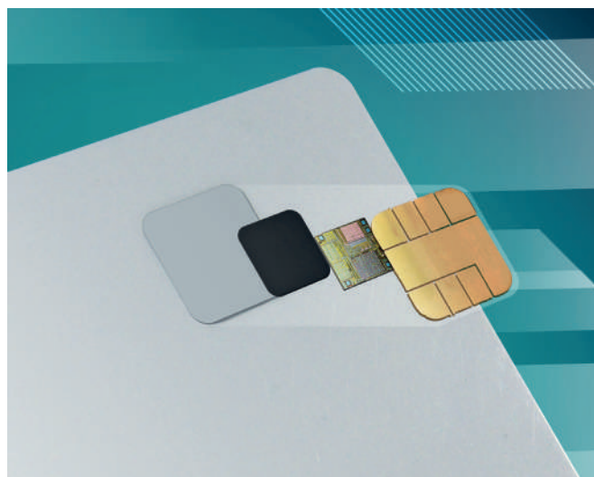
Рис. 5. Имплантация модуля в корпус карты
