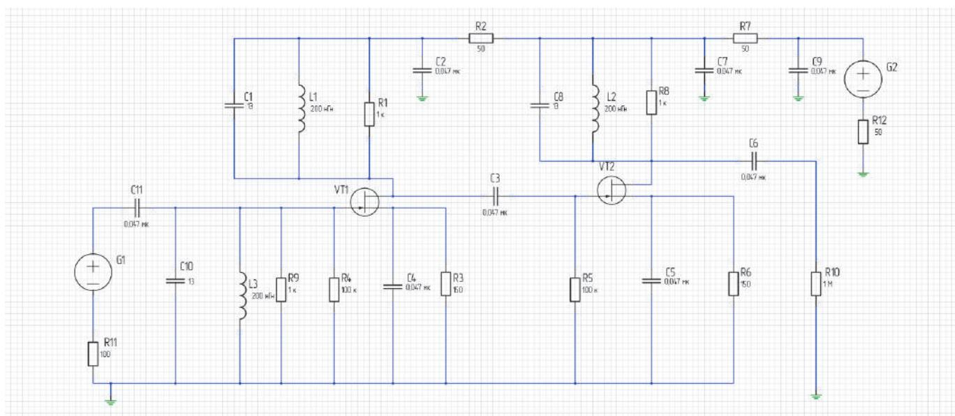
Рис. 2. Схема электрическая принципиальная преселектора
