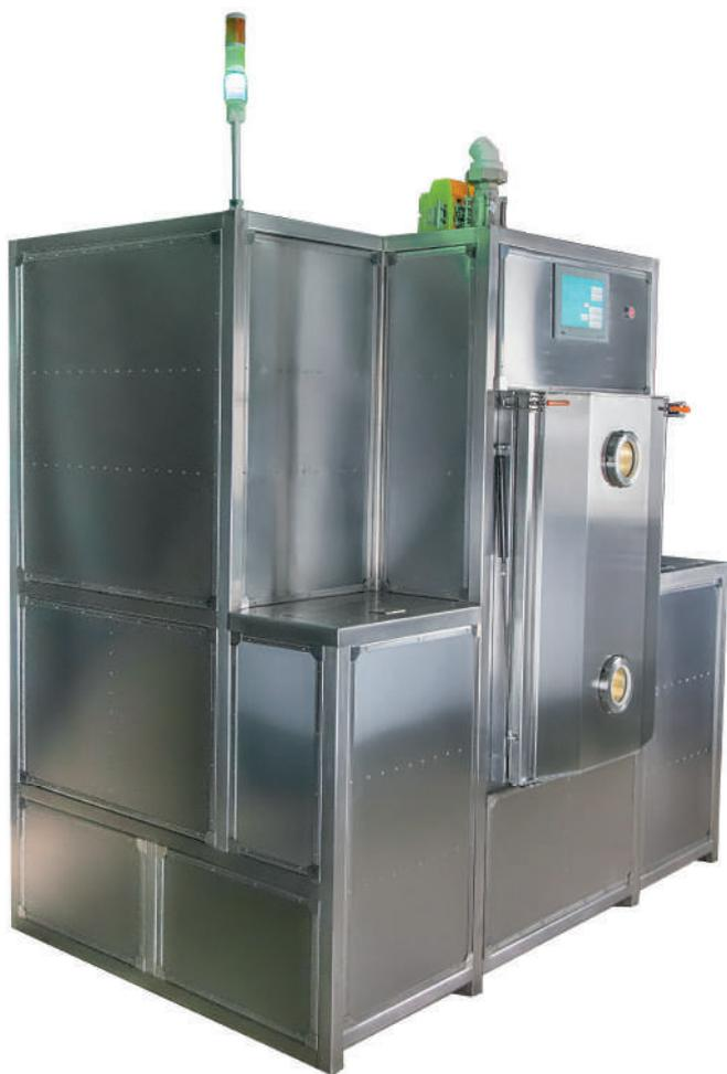
Рис. 7. Установка струйной отмывки в вакууме УСОТП-1
