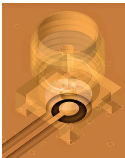
Рис. 7. Место установки коаксиального соединителя SMA
