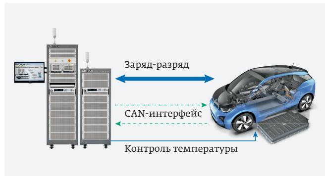
Рис. 4. Регулировка параметров заряда-разряда АКБ через CAN-интерфейс
