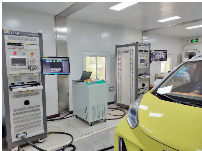
Рис. 9. Испытание АКБ электромобиля
