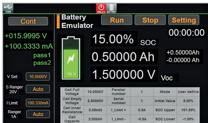
Рис. 7. Интерфейс блока имитации батареи
