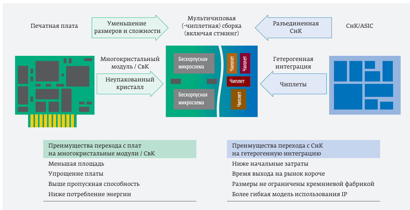
Рис. 3. СвК/многокристалльные модули в сравнении с архитектурами на основе чиплетов (гетерогенная интеграция). Источник: Cadence [7]
