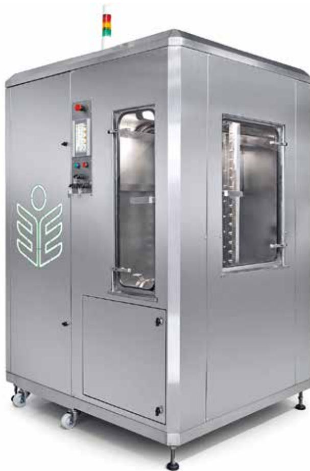
Установка струйной отмывки L 2 O. Производитель ООО «СПБЦ «ЭЛМА» (Россия)
