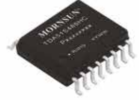
Корпус: Chiptlet SOIC Габариты: 10,2 x 7,4 x 2,35 мм
