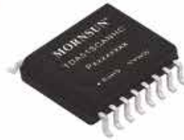
Корпус: Chiptlet SOIC Габариты: 10,3 x 7,5 x 2,5 мм
