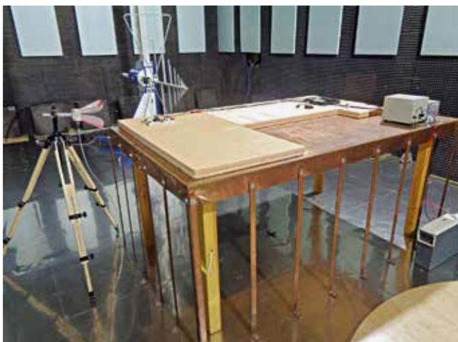
**Рис. 5.** Рабочее место для измерения напряженности поля широкополосных и узкополосных помех, создаваемых УВЭОС
