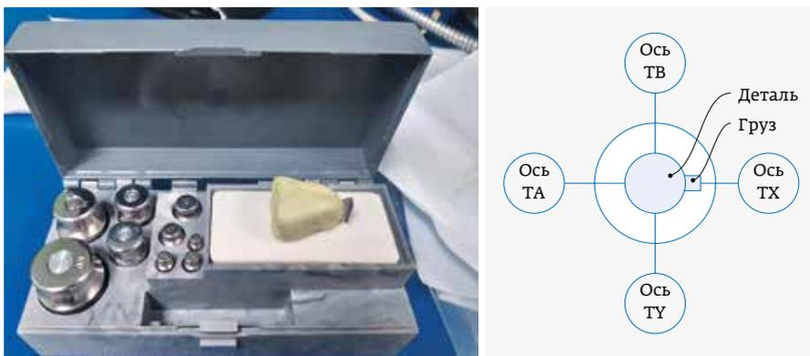
**Рис. 2.** Набор эталонных гирь (слева) и схематичное представление осей кругломера и расположения экспериментальной детали с грузом (справа)
