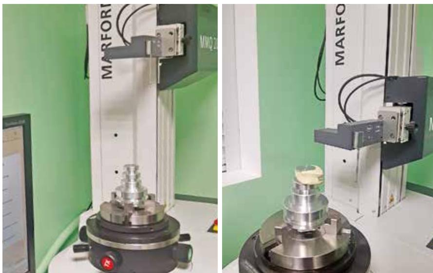
Рис. 1. Вид детали на кругломере без пригруза (слева) и с пригрузом (справа)
