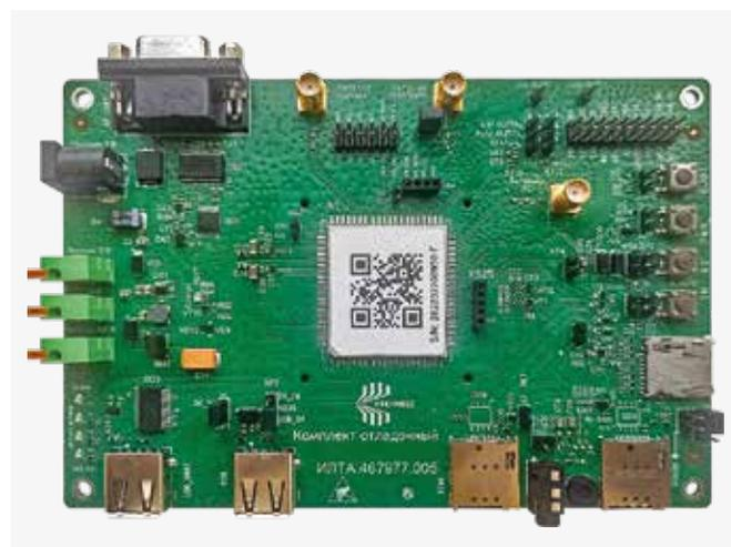
**Рис. 3.** Отладочная плата на базе модуля ПР1803 АО «НИИМА «Прогресс»
