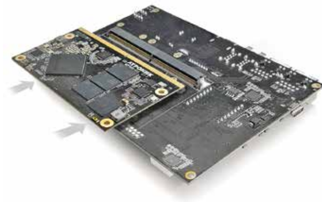
Рис. 1. Компьютерный модуль стандарта SMARC с несущей платой
