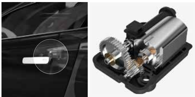
Рис. 9. Автомобильная ручка с возможностью автоматического выдвижения (слева, белым выделен привод) и привод для автомобильной ручки (справа)
