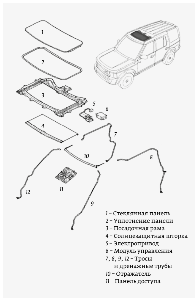
Рис. 10. Устройство сдвижного люка автомобиля
