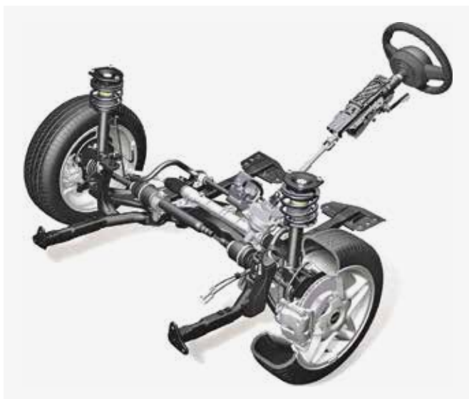
Рис. 1. Гидравлическая рулевая рейка
