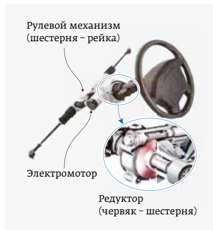
Рис. 3. Устройство ЭУР
