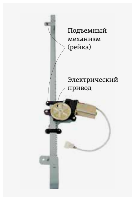
Рис. 14. Реечный механизм стеклоподъемника
