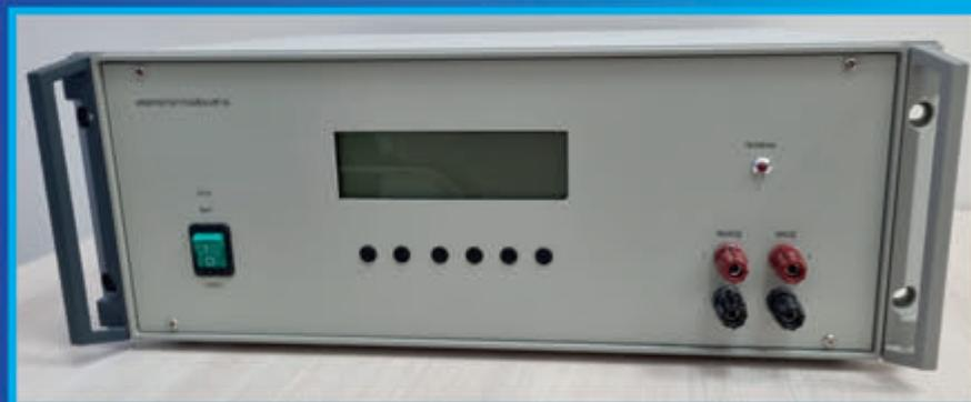
ИП-6 – испытательные импульсы: 1, 2a, 2b по ГОСТ 33991-2016
