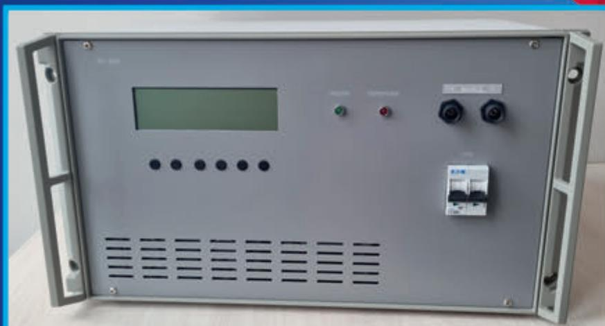
ИП-2БМ – испытательные импульсы: 2b, 4 по ГОСТ 33991-2016
