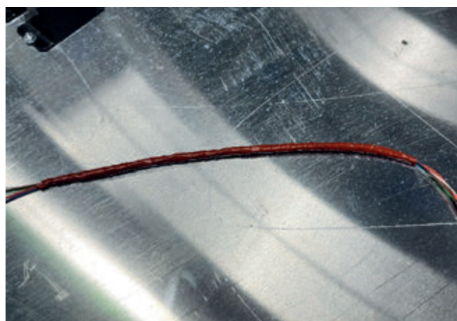
Рис. 3. Жгут намотан с удлинением ленты примерно на 1 / 3
