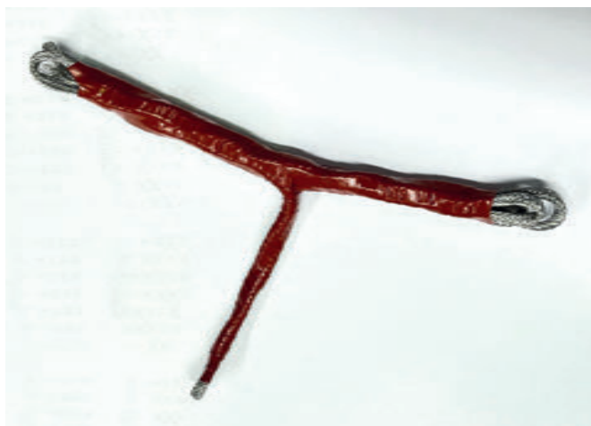
Рис. 5. Обмотка лентой ЛÉTСАР жгута с ответвлением
