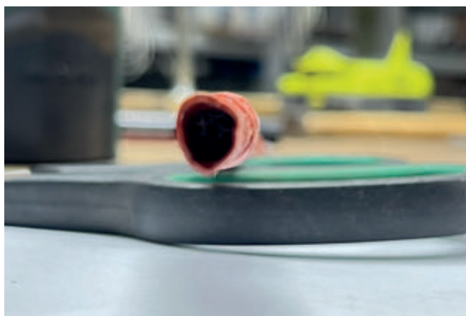
Рис. 6. При обмотке лентой получается резиновая трубка на проводах
