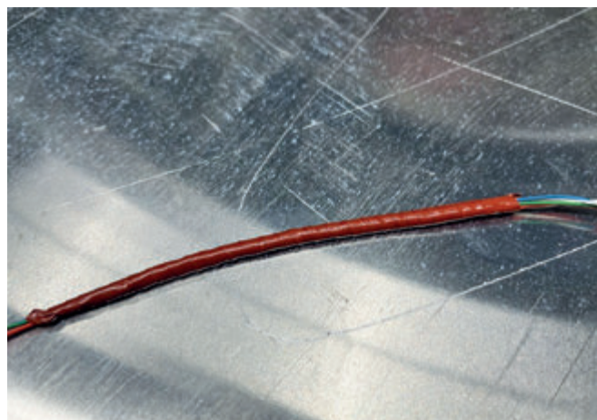
Рис. 4. Жгут намотан без удлинения ленты
