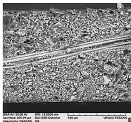
Рис. 8. Структура прокладки, сделанной из композита, армированного сеткой
