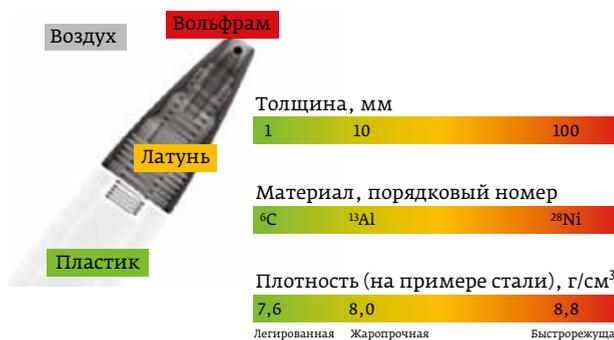
Рис. 1. Параметры образца, влияющие на поток прошедшего излучения
