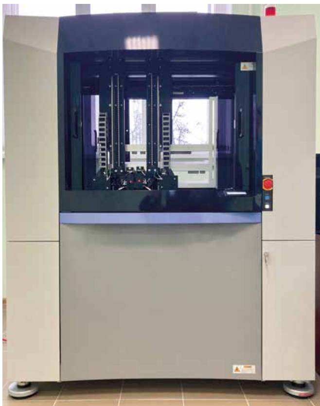
Рис. 2. Установка тестового контроля с «летающими» щупами
