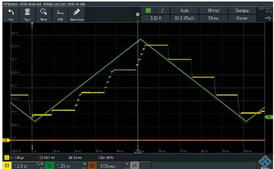
**Рис. 1.** Изменение значения выходного напряжения РИЭ (желтый цвет) при воздействии сигнала аналогового управления (зеленый цвет)
