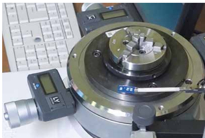
Рис. 3. Опускание щупа кругломера на пленку
