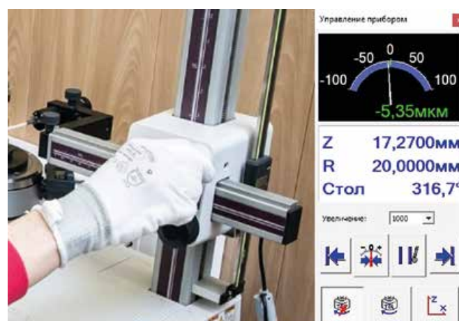
Рис. 4. Процесс настройки консоли щупа кругломера
