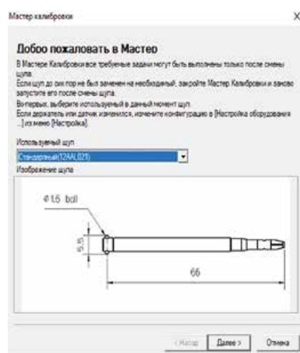
Рис. 4. Процесс настройки консоли щупа кругломера
