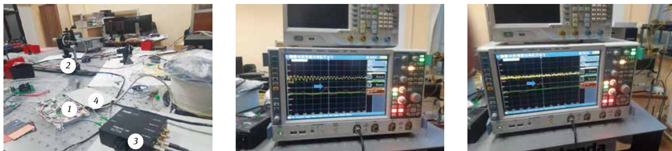
Рис. 11. Схема установки: (а) 1, 4 – волоконно-оптический тракт, 2 – микрометрический винт с установленным коллиматором, 3 – фотоприемник. (б) – показания осциллографа Rohde and Schwarz при смещении микрометрического винта на 0,05 мкм
