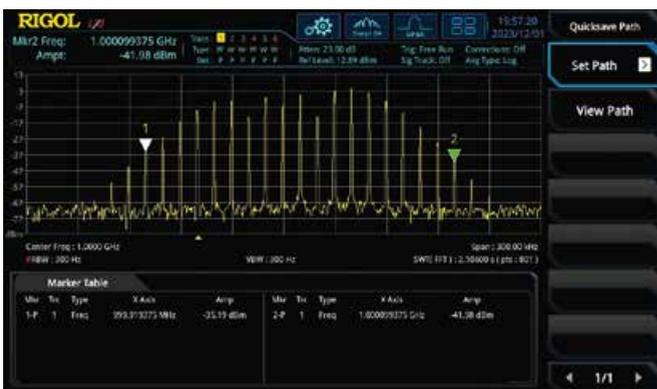
Рис. 16. Результаты измерений занимаемой полосы сигнала с АЧМ
