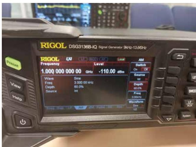
**Рис. 10.** Вкладка настройки AM генератора Rigol DSG3136B-IQ
