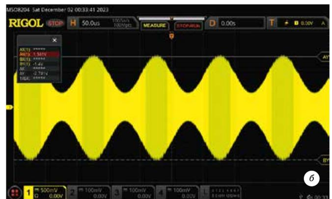
**Рис. 14.** Курсорные измерения по огибающей для расчета глубины АМ: а – для минимума; б – для максимума
