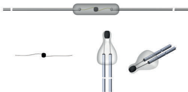
Рис. 6. Терморезисторы прямого подогрева с отрицательным температурным коэффициентом сопротивления ТР-1, ТР-2 и ТР-4
