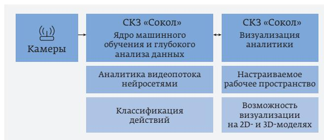
Рис. 1. Архитектура системы компьютерного зрения «Сокол»
