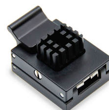
Рис. 2. Контактирующие устройства с теплоотводами
