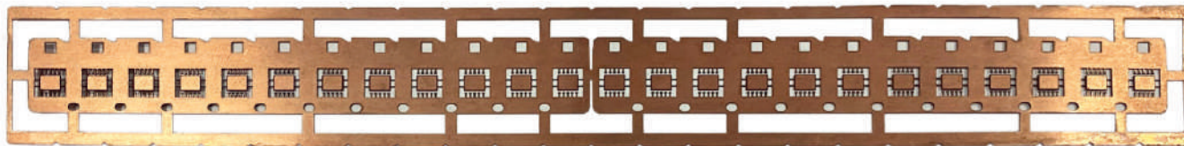
Рис. 3. Выводная рамка для металлополимерного корпуса DFN-10, полученная методом лазерного выжигания
