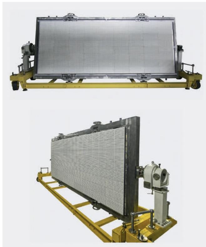
Рис. 1. ЦАР бортового радиолокатора «Касатка-Р» (АО «НИИ ТП»)
