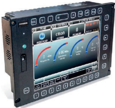
Рис. 16. Дисплей машиниста БИ05 на базе КМ МЦП1301 формата COM Express (производитель – НПК «АТРОНИК»)
