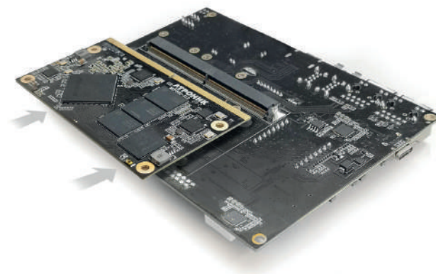
Рис. 2. Несущая плата с компьютерным модулем
