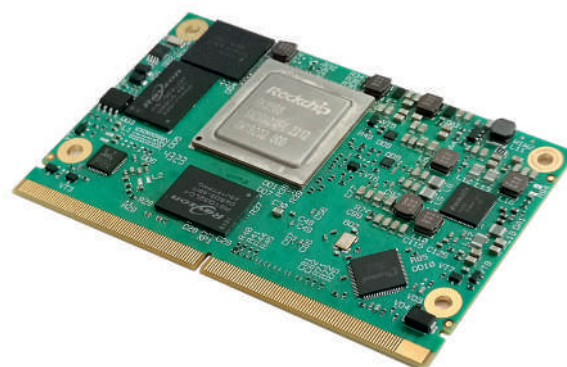
Рис. 11. Внешний вид модуля SMARC (производитель – НПК «АТРОНИК»)
