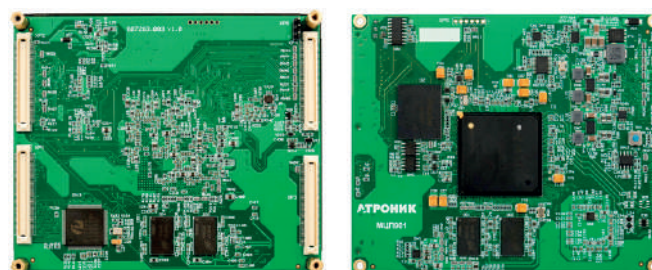
Рис. 7. Внешний вид модуля формата ETX (производитель – НПК «АТРОНИК»)
