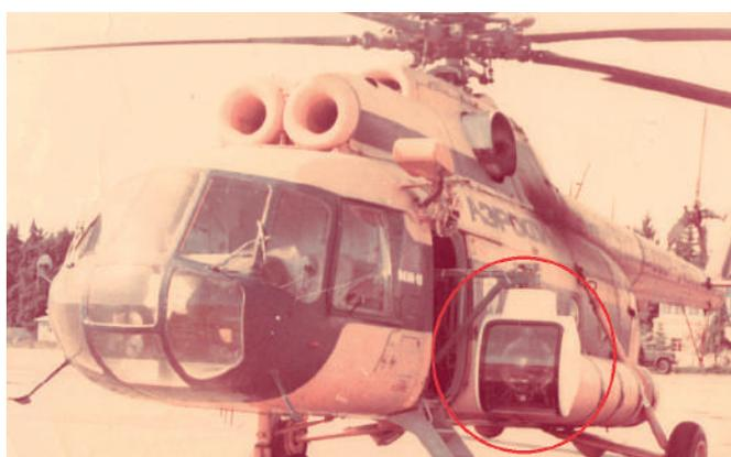
**Рис. 5.** Гиросtabilизатор 2ГСП, установленный на вертолете [7]
