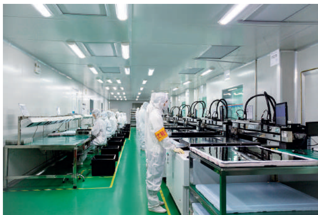
Рис. 1. Участок производственной линии компании KingTech по изготовлению TFT ЖК-панелей
