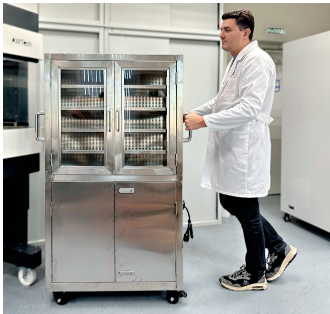
Рис. 5. Мобильный шкаф-тележка для перевозки чистых продуктов с HEPA-фильтрацией воздуха в рабочей зоне
