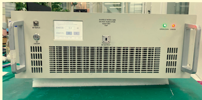
Рис. 2. Усилитель Ka-диапазона мощностью 100 Вт QAS2640-P50
