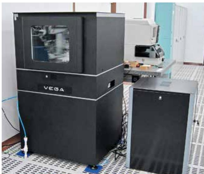
Еще одна новая установка на производстве ООО «БУТИС»: атомно-силовой микроскоп производства ООО «НТ-МДТ», применяемый для контроля и исследования структур на пластинах
