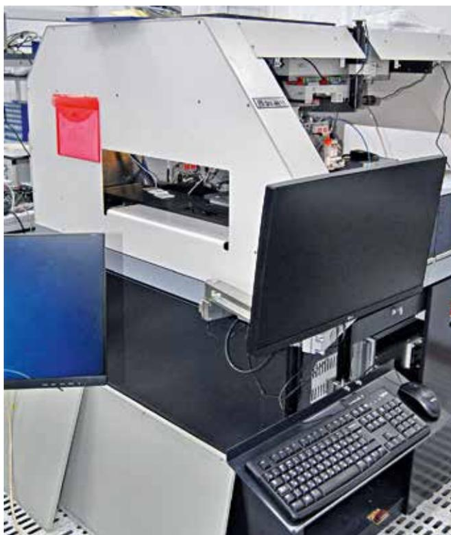
Установка посадки кристаллов ЭМ-4615 производства ОАО «Планар»
