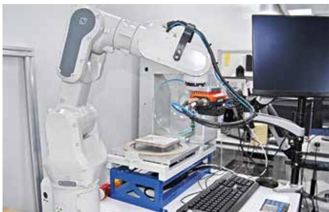
Робототехнический комплекс герметизации корпусов фильтров. На заднем плане – одна из печей пайки крышек к основаниям корпусов
