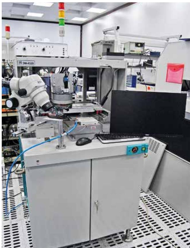
Автоматическая установка электрического соединения кристалла и корпуса (проволочной разварки) и формирования бампов на пластине производства ОАО «Планар»
