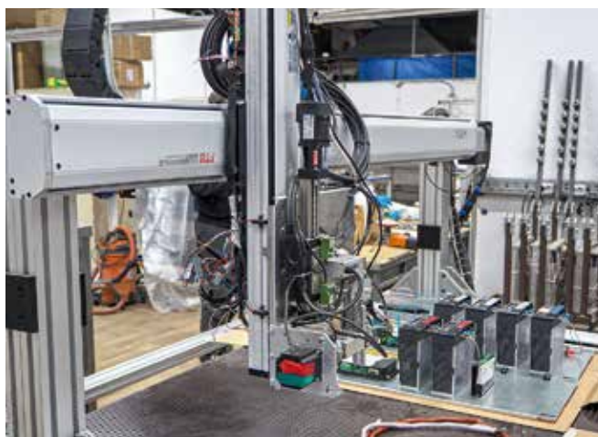
Координатный станок с ЧПУ для раскладки проводов жгута. В нижней части – перфорированный стол; в центре – головка, выполняющая раскладку
