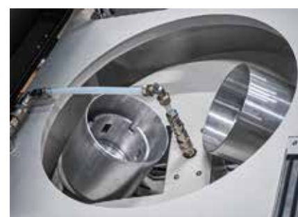
Вакуумный компрессор и трубопровод откачки воздуха
