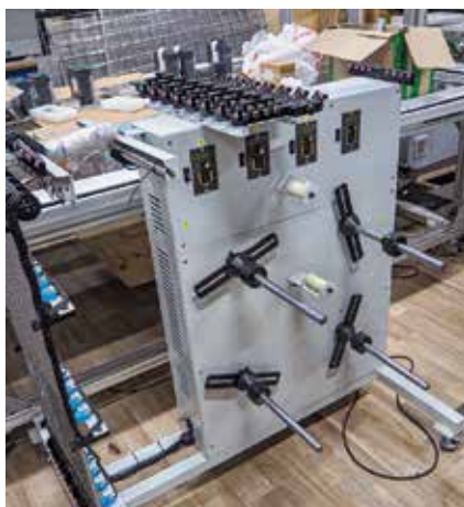
Установка подачи проводов с катушек
