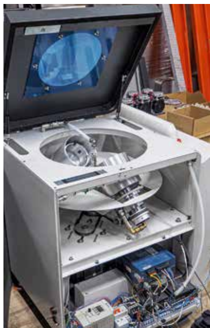
Планетарный миксер Соло ВКС М в процессе изготовления
