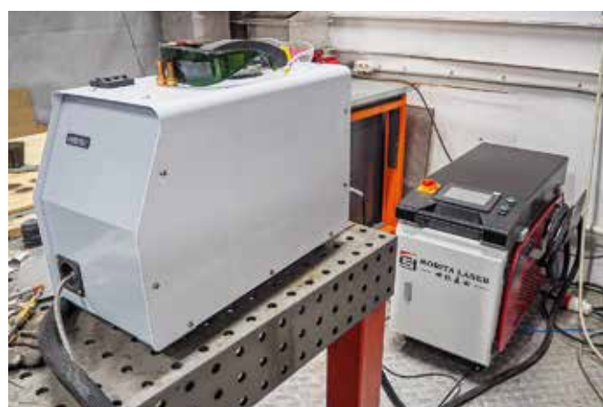
Сварочный пост с оборудованием для лазерной сварки
