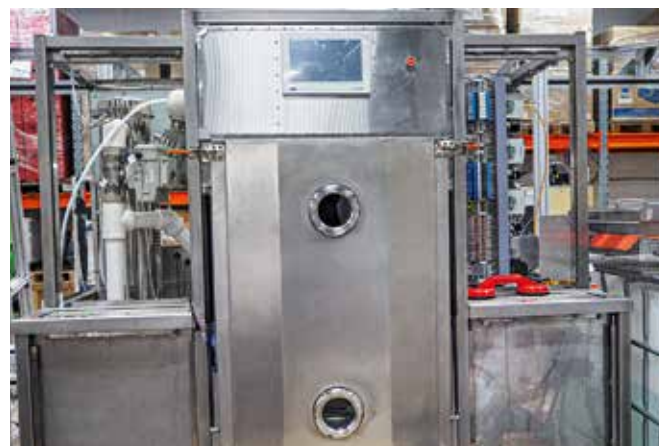
Установка струйной отмывки с вакуумированием УСОТП-1
