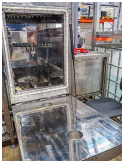
Внутренний объем камеры установки струйной отмывки
