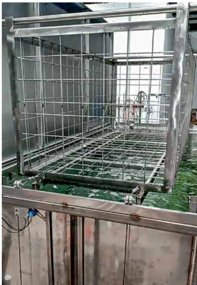
Ванна ультразвуковой отмывки с подъемным механизмом. Фото предоставлено ООО «Протех»
