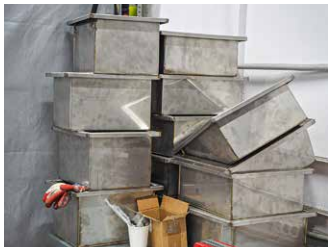
Сварные емкости собственного производства для УЗ-ванн ХимСоник серии «Профи»
