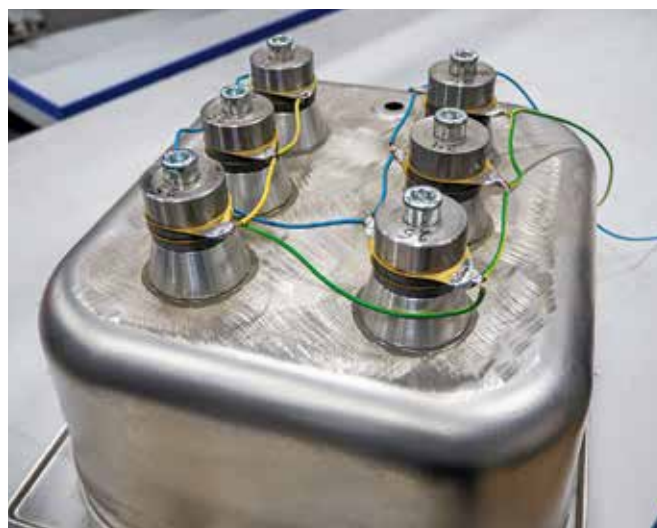
Ванна с приклеенными излучателями
