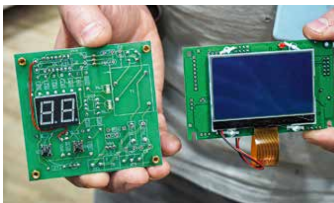
Электронные схемы управления: слева – аналоговая; справа – цифровая
