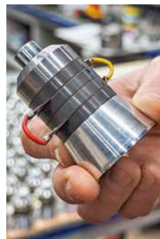
УЗ-излучатель с двумя рабочими частотами
