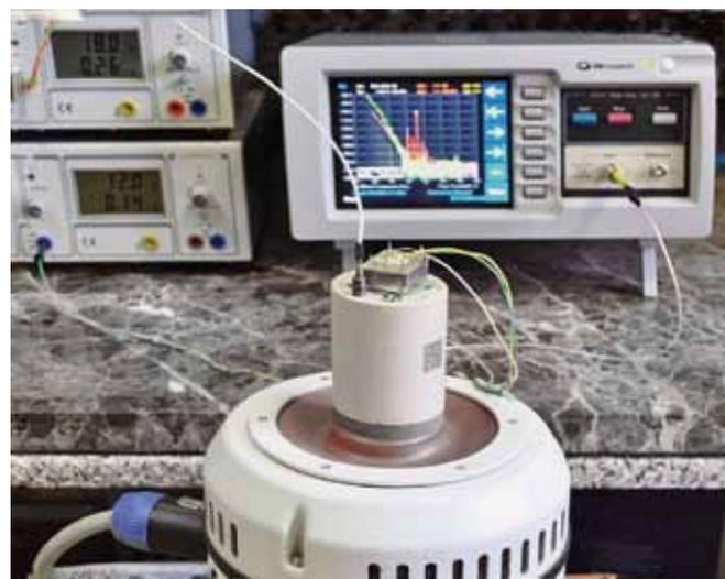
Рис. 17. Измерение G-чувствительности под воздействием вибрации
