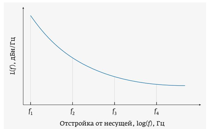
Рис. 11. Спектральная плотность мощности фазовых шумов
