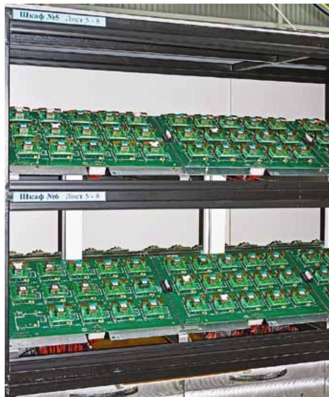
**Рис. 8.** Оборудование для испытаний кварцевых генераторов на долговременную нестабильность
