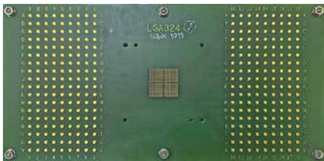
Рис. 3. Печатная плата, на которой осуществляется монтаж УК
