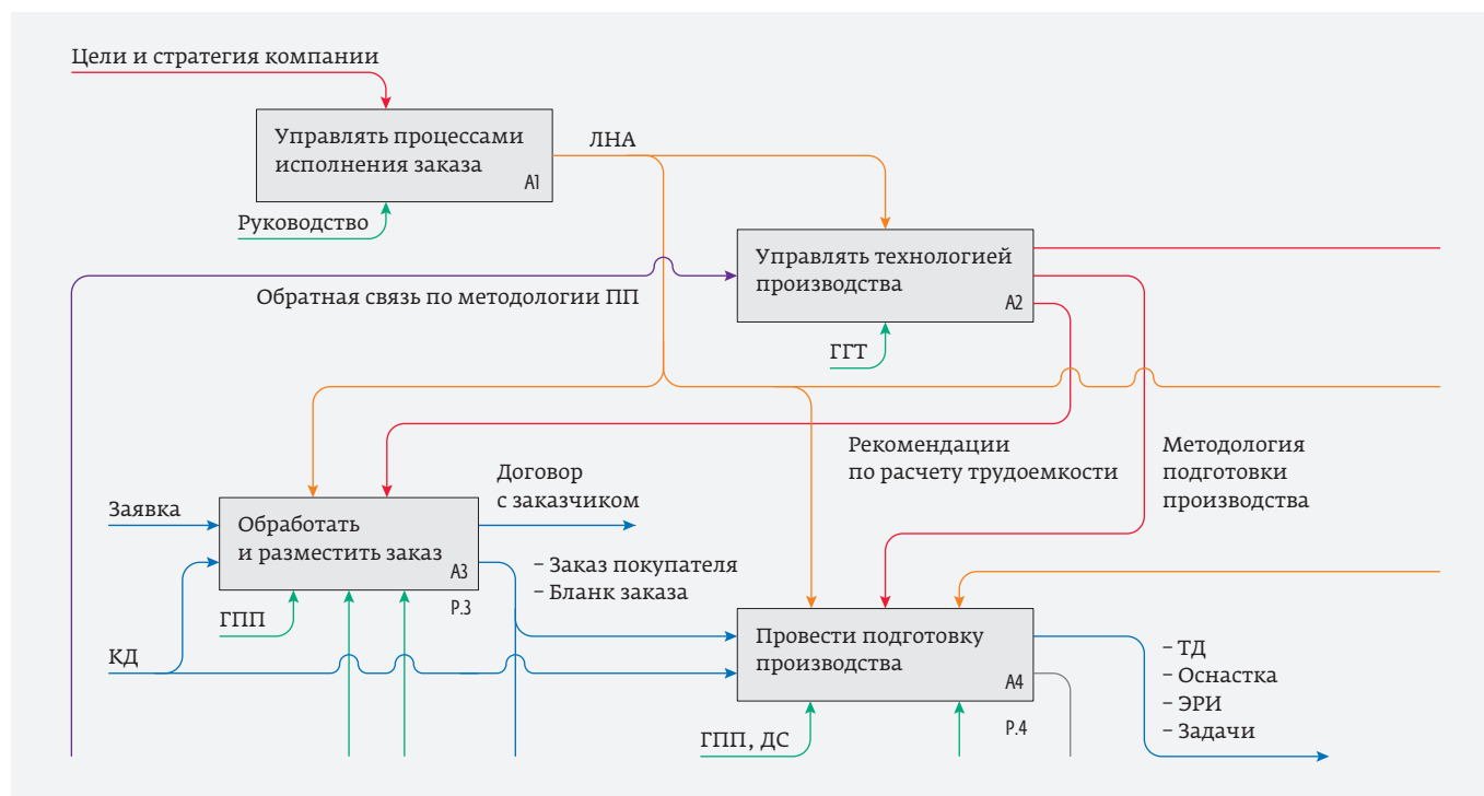
Рис. 2. Фрагмент модели производственной деятельности в нотации IDFO AS IS (ЛНА – локальные нормативные акты, ПП – печатные платы, ТД – технологическая документация, ДС – давальческое сырье, ЭРИ – электрорадиоизделия, ГГТ – группа главного технолога, ГПП – группа подготовки производства)
