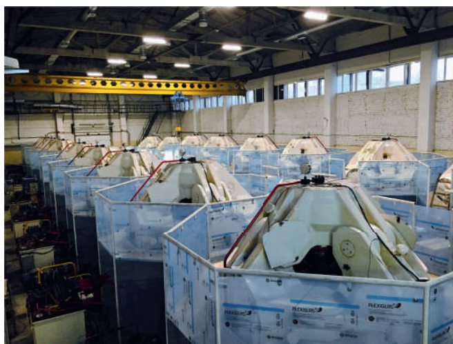
Рис. 3. Цех кубических прессов для выращивания монокристаллов алмаза (фотографии представлены ООО «Нью Даймонд Технолоджи»)
