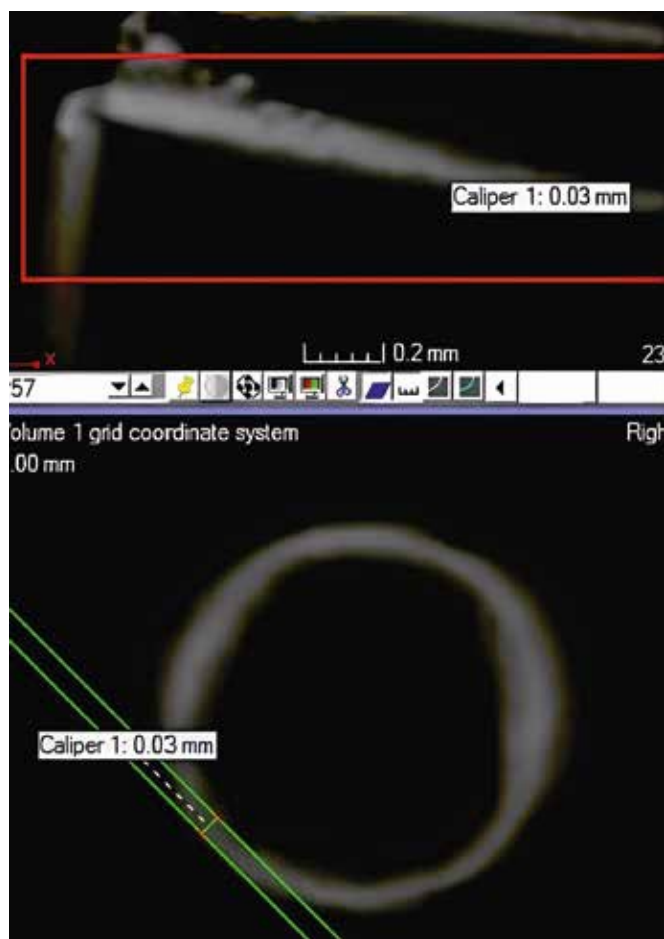
Рис. 5. Неравномерность толщины покрытия ПП (выделено красным)
