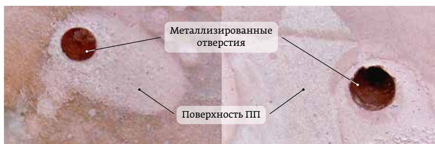
Рис. 1. Внешний вид заготовок после металлизации. Снято с 50-кратным увеличением. Справа – заготовка, активированная по графитовой системе, слева – с помощью комплекса ГФМ
