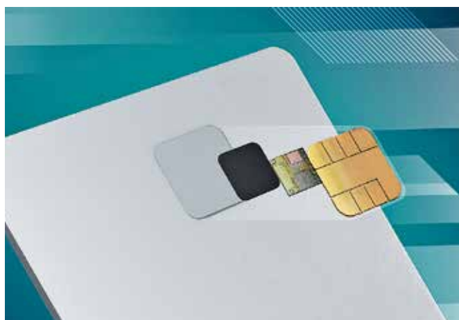
Рис. 2. Модуль микроконтроллера K5004BE1 в интеллектуальной карте
