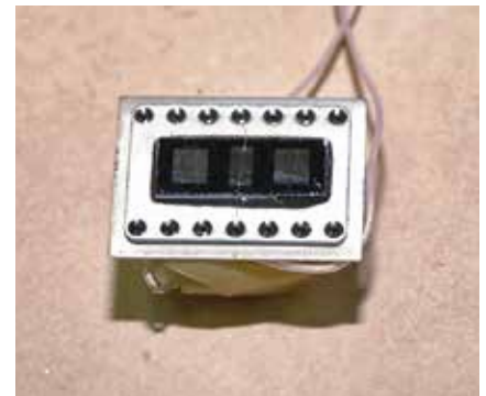
Рис. 4. Фотопьезоэлектрический приемник оптических сигналов на ПАВ в корпусе с выводами
